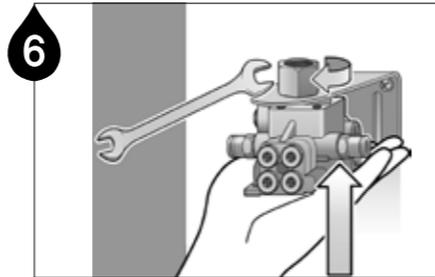
Verbinden Sie den Progressivverteiler am Adapter, der Unterlegscheibe und der Montagehalterung und drehen Sie den Adapter (A002) zum Festziehen im Uhrzeigersinn.
