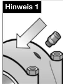
**Hinweis 1** Installieren Sie direkt auf der Schmierstelle eine A240 Push-Fit Rohrverschraubung.
