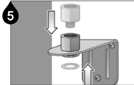
Installieren Sie den Adapter (A002) an der montierten Montagehalterung mit der Unterlegscheibe (B058) an der Unterseite.
