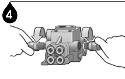
Schrauben Sie die Steckverbinder an jedem Ausgang des Progressivverteilers.
