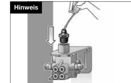
Füllen Sie den Verteilerblock mit einer Fettpresse und einem 3/8" Schmiernippel mit demselben oder einem kompatiblen Fett vor.
