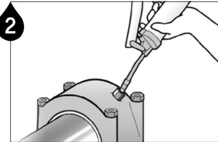
Stellen Sie mit einer Fettpresse einen freien Durchgang sicher. **Hinweis 1** Entfernen Sie ausgehärtetes Fett, indem Sie die Schmierstelle mit einer manuellen Fettpresse spülen. **Hinweis 2** Das Fett im Gerät und das im Gerät enthaltene Fett sollten gleich oder kompatibel sein.
