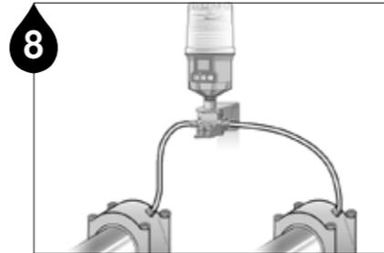
Für typische Lageranwendungen installieren Sie den Progressivverteiler mit Kupfer- oder Nylonleitungen am Gerät.
