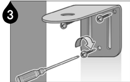
Installieren Sie die Montagehalterung (B002) an einer geeigneten Position mit den Schrauben (B051).
