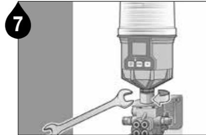
Installieren Sie den Schmierstoffgeber mit einem 17-mm-Schlüssel an der Halterung.
