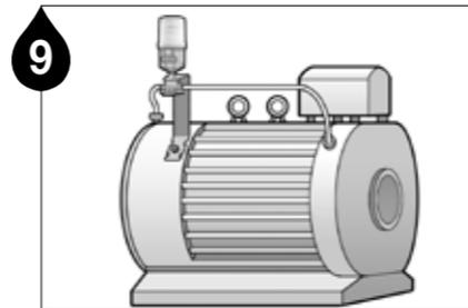
Installieren Sie für Motorlageranwendungen die Montagehalterung an einer geeigneten Stelle mit dem 2-Punkt-Ferninstallationsatz und verbinden Sie dann beide Lager mit Schmierleitungen.
